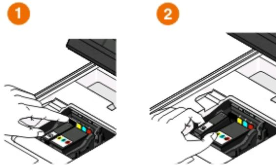
**警告—可能的损坏：** 请不要取出旧的打印墨盒，直到您准备好新的打印墨盒，否则打印头中剩余的墨水可能会干燥并堵塞喷头。
