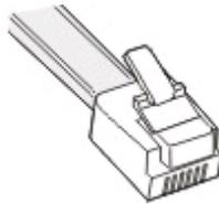
打印机后面的传真插口和随同打印机一起提供的电话线都是 **RJ-11** 的。如果您所在的国家或地区使用不同类型的插座，您可能需要使用 **RJ-11** 适配器。
