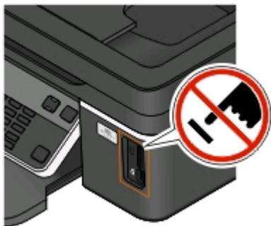
**警告—可能的损坏：**当正在打印、读取或写入存储设备时，请不要触摸任何电缆、任何网络适配器、任何接口、存储设备或图中所示的打印机区域，否则可能会发生数据丢失。
