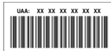
**注意：**您可以在接入点（路由器）上设置一个 MAC 地址列表，只允许 MAC 地址相符的设备使用网络。这称为 *MAC 过滤*。如果您在您的接入点上启用了 MAC 过滤功能，并且希望将一台打印机添加到网络中，打印机的 MAC 地址必须包含在 MAC 地址列表中。
