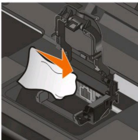
**警告—可能的损坏：** 请不要触摸打印头墨水过滤器或打印头喷头。
