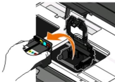
**警告—可能的损坏：** 请不要触摸打印头墨水过滤器或打印头喷头。
