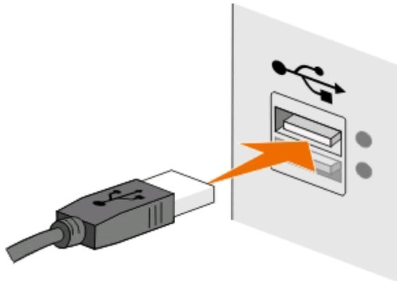
2 将较小、较方的一端连接在打印机的后面。
