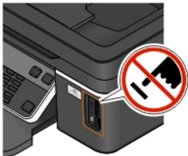
**警告—可能的损坏：**当正在从 PictBridge 兼容数码相机中打印时，请不要触摸 USB 电缆、任何网络适配器、任何接口或图中所示的打印机区域，否则可能会发生数据丢失。
