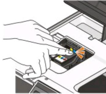
**注意：**取下保护盖后请立刻安装新的打印墨盒，以避免墨水暴露在空气中。
