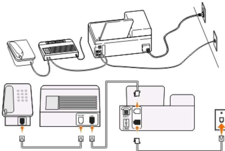
连接在不同的墙壁电话线插座上
